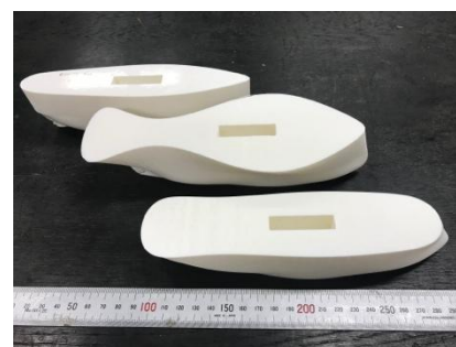
学習過程で探索された 船体の 3D プリンティング模
